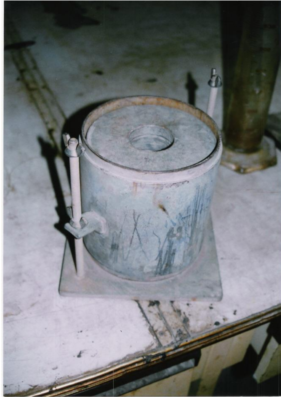
شكل رقم (4.2.3.3.19) - القرص المجالي فوق قالب نسبة تحمّل كاليفورنيا (CBR)
