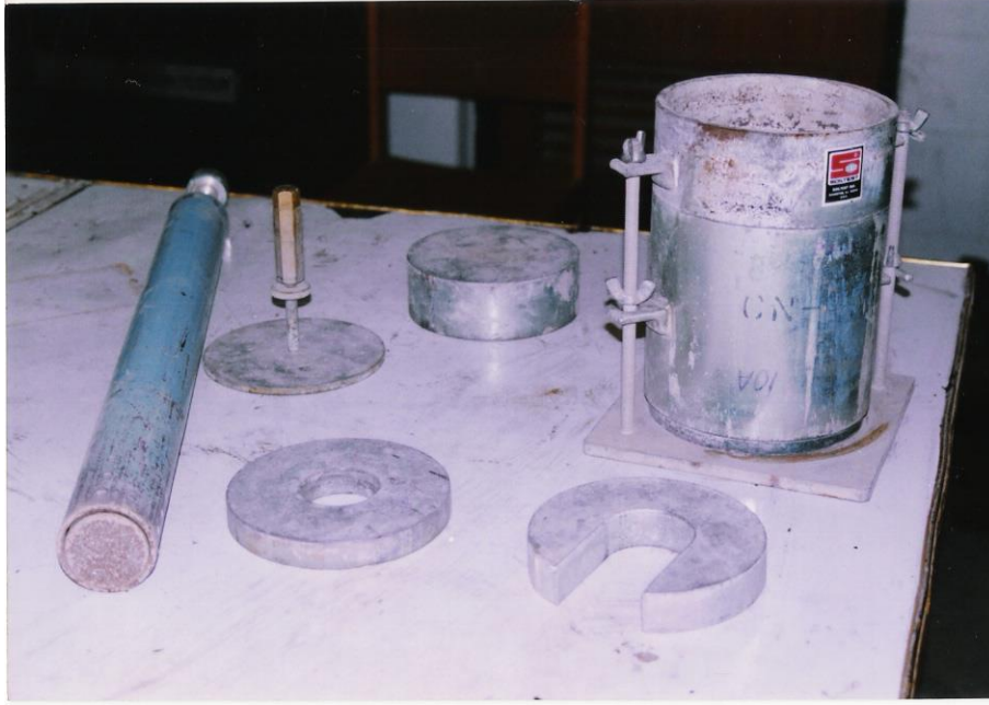
شكل رقم (1.3.5.3.19) - اجزاء قالب نسبة تحمّل كاليفورنيا (CBR) باتباع المواصفات الامريكية (ASTM)
