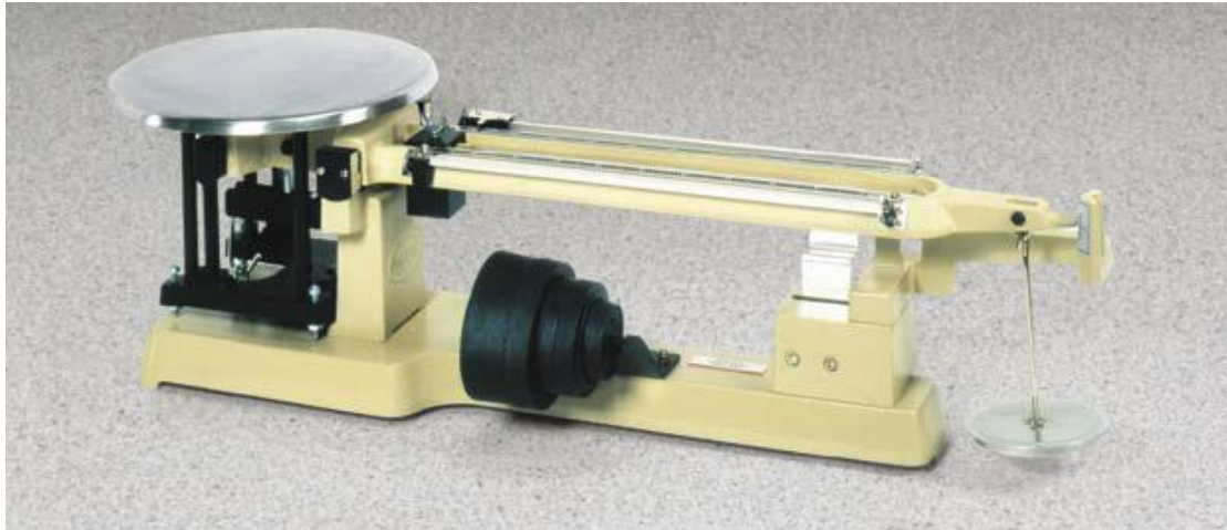
شكل رقم (1.1.2.3.19) - ميزان بطاقة 20 كيلوغرام منتج من قبل شركة ELE البريطانية
