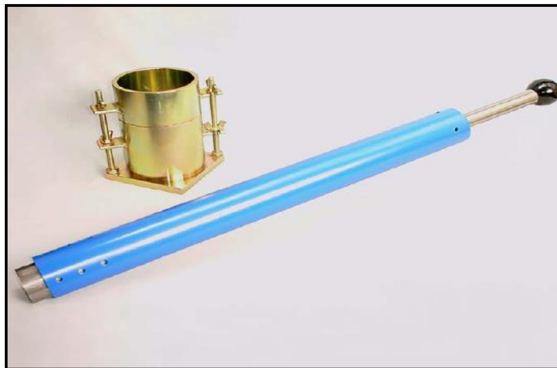
شكل (٣) القالب المستخدم في دمك التربة والمطرقة
